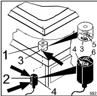
Este dispositivo de seguridad, constituido por un imán [1] de modelo aprobado y con un contacto magnético [2] tiene la misión de evitar daños causados por el arranque sin querer del agitador cuando la tapa esta abierta. Por eso, el aparato no puede funcionar con la tapa abierta y si viene abierta durante el funcionamiento, el agitador se para de repente.
