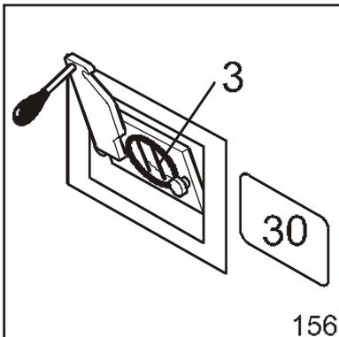
En los modelos con mayores capacidades, equipados de portezuela de extracción, la rejilla fija de protección [3] impide, por lo posible, introducir ACCIDENTALMENTE los dedos u objetos. Para asegurar la operación de la maquina no es posible ajustar la rejilla, así evitando la inserción de objetos o dedos (**como establece la Directriz Máquinas 89/392/CEE y siguientes variaciones, Anexo I, Artículo 1.1.2.b 3º apartado**).
