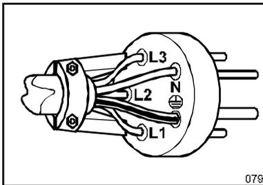
En el extremo del cable de alimentación hay que instalar una clavija (con 3 polares para alimentación monofásica 1N y con 5 polares, para alimentación trifásica 3N – 3F) adecuada a la toma eléctrica de alimentación.
