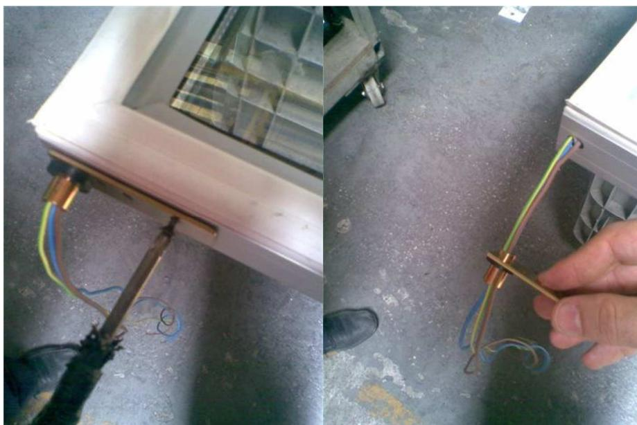
7. Retirez le couvercle en plastique situé sur le côté de la porte et faites sortir les câbles par ce trou.
