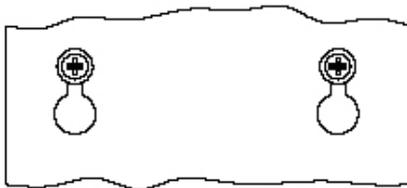
Asegúrese de que los tornillos encajen perfectamente en el accesorio de instalación en pared.
