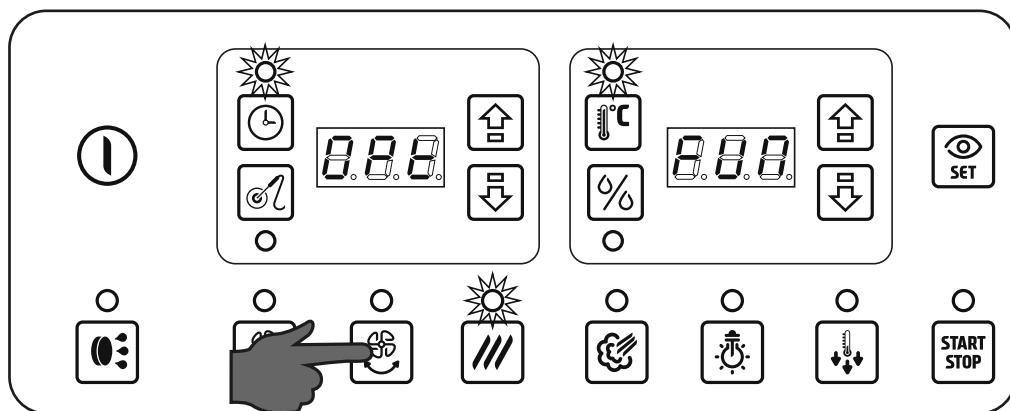
Wenn diese Funktionen nicht mit dem Ofen gekauft worden sind, drücken Sie eine der Tasten Auto-reverse oder verminderte Lüftung und auf den Displays erscheint die Anzeige **Fun OPT** (Function optional) um zu zeigen, daß die eingestellte Funktion optional ist und nicht auf dem Ofen installiert ist.
