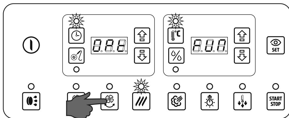
Si ces fonctions ne sont pas été achetés en même temps que le four, en appuyant sur un des boutons de l'Autoreverse ou de la ventilation réduite, le panneau affiche le message **Opt FUN** (Fonction optionnelle) pour indiquer que la fonction sélectionnée est une option qui n'a pas été installé sur le four.
