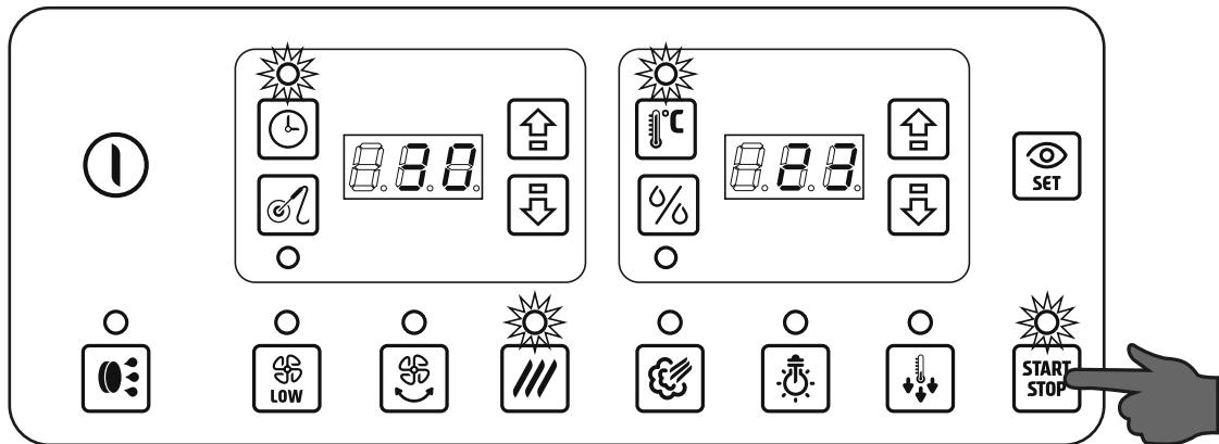
**En appuyant sur le bouton marche / arrêt, illustré sur le côté, il est possible de commencer la phase de cuisson.**
