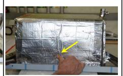
3- Percer l'isolant. (Ex: à l'aide d'une clé à tube)
