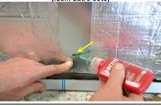
7- Visser l'écrou. Il doit être aligné sur l'extrémité du goujon. (Voir photo) (Idem autre côté)
