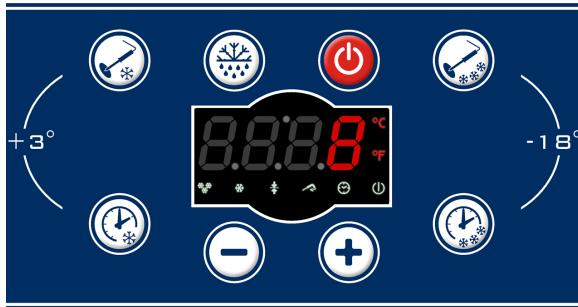
L'accès à la procédure pour la programmation des paramètres de configuration est exclusivement permis dans l'état de '**STAND-BY**'.
