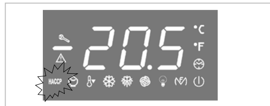
Dieses LED zeigt einen Alarmzustand HACCP an.
