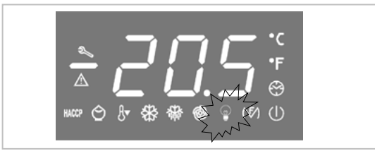
Diese LED zeigt den Zustand (ein oder aus) des LICHTS an
