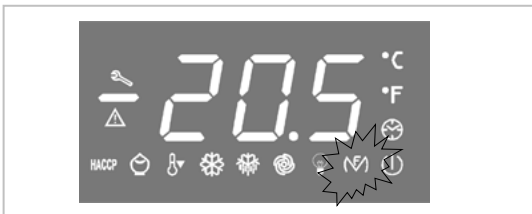
Diese LED zeigt den Zustand (ein oder aus) der TÜRHEIZELEMENTE an
