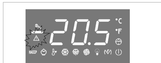
Este LED indica un estado de ALARMA / AVERÍA.
