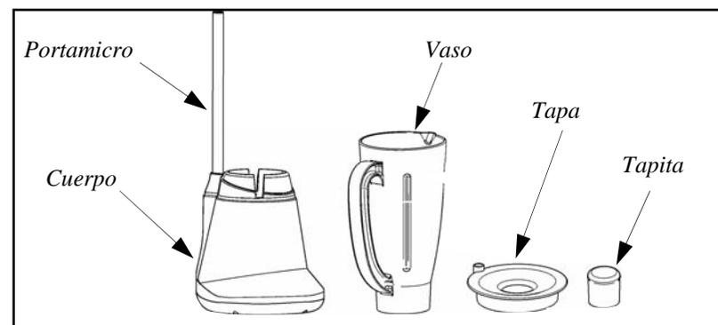
FIG n°10 - Aparejo desmontado para ser limpiado
