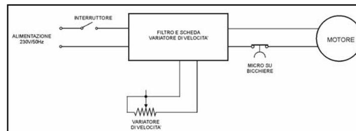
FIG. n°6 - Esquema elettrico Mn, con variador de velocidad
