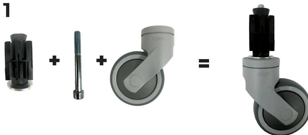
► Pour le montage, vous devez passer la vis de la douille expansible par le dessous du trou central et recomposer dans l'ordre la douille expansible. Il ne reste plus qu'à serrer légèrement la vis sous la monture.
