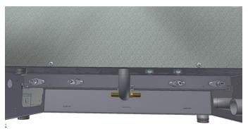
Nach dem Entfernen der Brenner abschrauben Brennerdüsen die je zwei links und rechts von Brennerdüsen.
