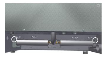
Lösen Sie die Schrauben des linken und rechten Brenner.
