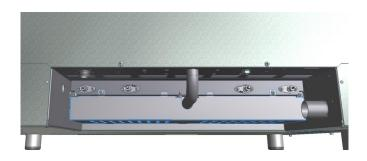
Lösen Sie die Schrauben der Abdeckplatte des Brenners.
