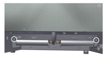
Desatornillar los tornillos que sujetan el quemador a la izquierda y a la derecha.  $\,$
