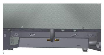
Después de retirar los quemadores, desenrosque los dos inyectores del quemador izquierdo y los 2 inyectores del quemador derecho.
