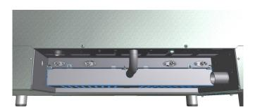
Destornillar los 2 tornillos que fijan el panel de la tapa del quemador.
