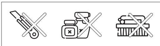
Zu jedem Reinigungsvorgang gehört auch die Reinigung des Kondensator-Verflüssigers, vor dem Kühlaggregat. Dafür ist die Schutzgitter wegzunehmen. Die Reinigung erfolgt, je nach Verschmutzung, mit einer weichen Bürste (keine Eisenbürste benutzen) oder mit einem Staubsauger.
