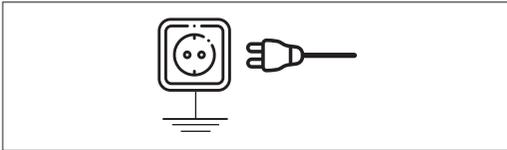
Das Kabel muss immer, höchstens 3 mt. weit, mit einem 0,03 A Differenzial-Magnetschalter angeschlossen werden. Kein direkter Anschluss der Hauptspeiseleitung. Überprüfen, ob die vorhandene Netzspannung mit den Angaben auf dem Leistungsschild übereinstimmt.
