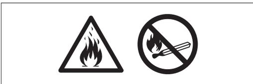
Das Kältemittel R290 ist ein umweltverträgliches, jedoch stark entflammbares Gas. Beim Transport, bei der Installation sowie bei der Verschrottung des Gerätes mit großer Vorsicht vorgehen und sicherstellen, dass die Leitungen des Kühlkreislaufs nicht beschädigt werden.
