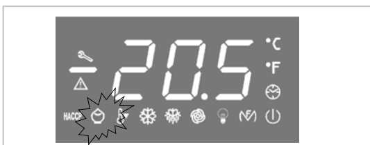
Dieses LED zeigt die Aktivierung der Funktion ENERGY SAVING an
