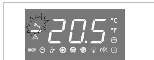
El LED se requiere la limpieza del condensador de filtro.
