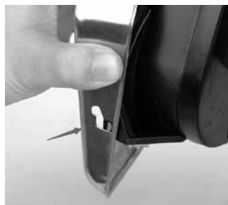
Montare la protezione coltello
