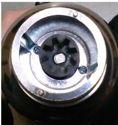
Napęd główny z wejściem typu żeńskiego, wykonanym z tworzywa sztucznego (222171)
